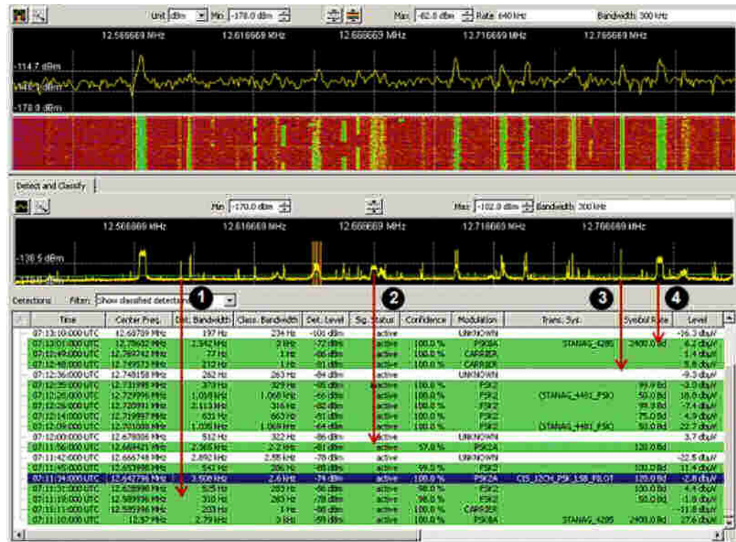
Рис. 1-3: Результаты классификации, на основе которых могут запускаться процессы автоматического производства (AP)
